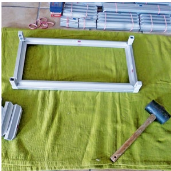
Ein bisschen wie ein Kinderspielkasten. Schritt für Schritt entsteht aus Profilen und Verbindungsstücken ein Modul.
