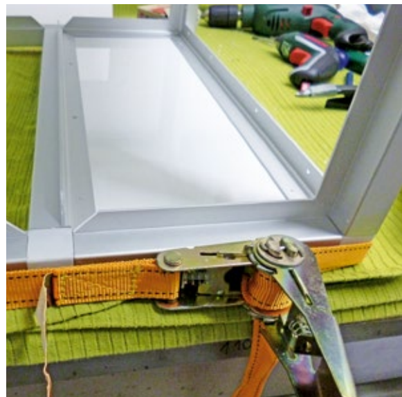
Zur Stabilisierung bei der Montage benutzt Katja Kalitzki Spannbinden. ➤
